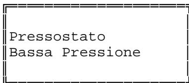
Intervento del pressostato di bassa pressione generale dell'impianto. Tutti i compressori verranno disattivati.
